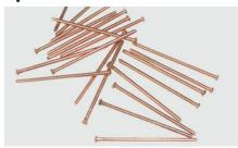
• Spine in acciaio per saldatura e tiraggio con macchine spotter. Diametri di 2,0 e 2,5 mm, lunghezza 50 mm. Realizzate in acciaio con ramatura superficiale.
