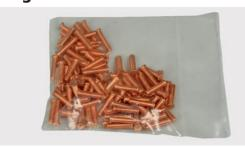
Prigionieri filettati M4, lunghezza 16 mm, in acciaio con ramatura superficiale anticorrosione. Si utilizzano saldandoli con macchine spotter e avvitandoci sopra gli stessi anelli utilizzati anche per i prigionieri filettati in alluminio/silicio o alluminio/magnesio.
