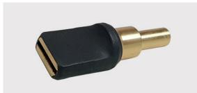
• Elettrodo per spotter per la saldatura delle rondelle asolate. Attacco cilindrico per pistola, di diametro 10 mm. Lunghezza dell'elettrodo 48 mm, lunghezza totale 70 mm.
