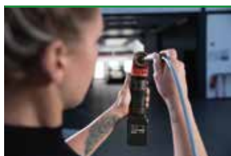
Cambio rapido innovativo Montaggio su PXE senza bisogno di attrezzi
