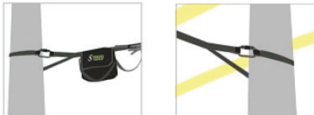
Prípád 2: Neexistuje žiaden kotviaci bod
