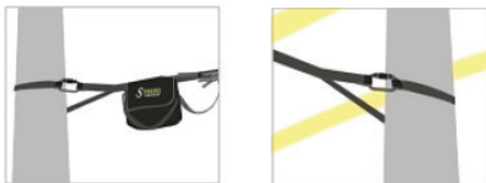
Caso 2: No existen puntos de anclaje
