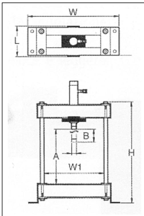
Pressa da banco e da officina a funzionamento idraulico, ideale per l'estrazione ed il montaggio di perni, cuscinetti, ingranaggi ed ogni lavoro di pressatura.
